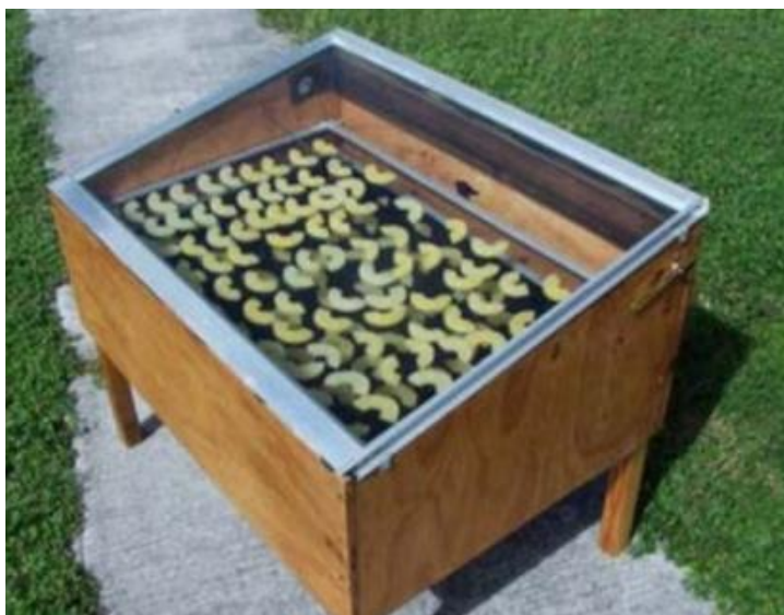
Figura 2: Secador de calor direto. Fonte: BRUNO KÄGI, 2015.
