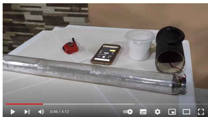
Figura 8 – Demonstração das ondas sonoras através do Tubo de Kundt
