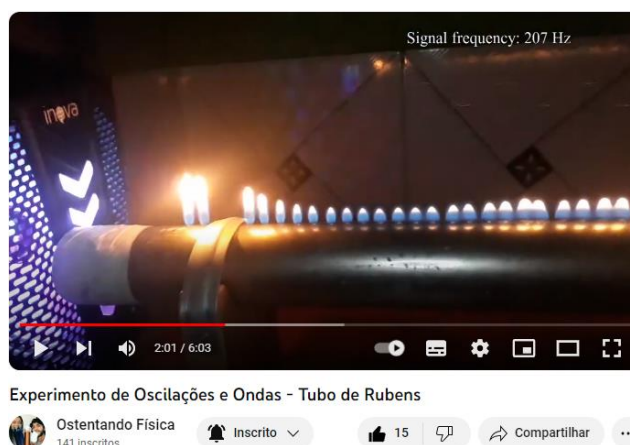
Figura 9 – Demonstração das ondas sonoras através do tubo de Rubens
