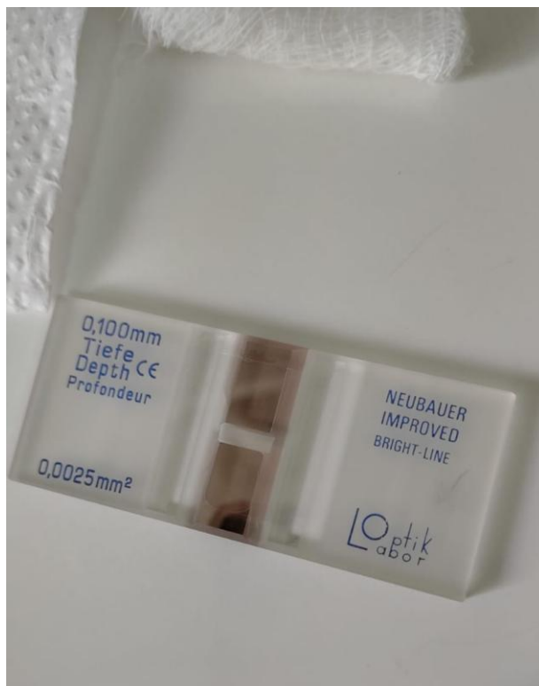
Figura 5: Câmara de Neubauer com amostra preparada para análise de concentração
